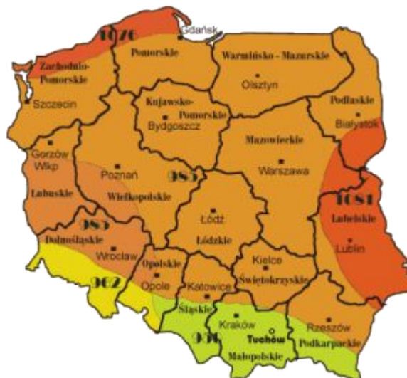
Rysunek 5. Rejonizacja średniorocznych sum promieniowania słonecznego całkowitego padającego na jednostkę powierzchni poziomej w kWh/m 2 /rok. Liczby wskazują całkowite zasoby energii promieniowania słonecznego w ciągu roku dla wskazanych rejonów kraju
